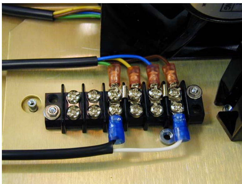
Figura 3.0-Configuración de puentes para 90 a 130 VCA.
